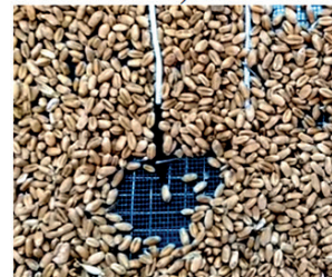
Рисунок 4. Экспериментальная установка для определения разогрева одинарного слоя зерна; а) схема установки; б) схема крепления спая термопары на зерне; в) размещение зерна на сетчатой поверхности. 1 – слой зерна; 2 – сетка; 3 – источник ИК излучения; 4 – отражатель; 5 – поддон; 6 – направление теплового излучения; 7 – отражатель
