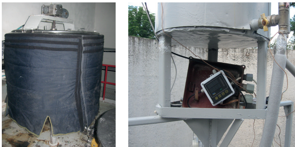
Рис. 2. Общий вид системы замера температурных данных на комплексном энергозамещающем устройстве и на емкости для сквашивания
