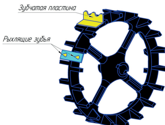
Рисунок 3. Установка зубьев и зубчатых пластин по бионическому подобию на кольчатом зубчато-шпоровом диске катка
