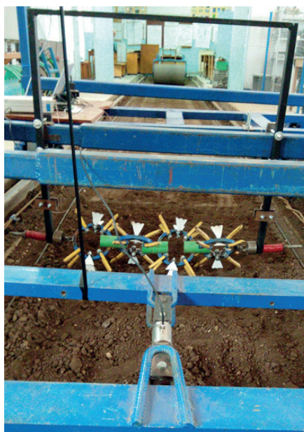
Рисунок 7. Общий вид канала с подвижной тележкой и исследуемым рабочим органом
