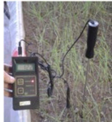
Рисунок 2. Замеры влажности почвы прибором TR Turoni 47122 Forli
