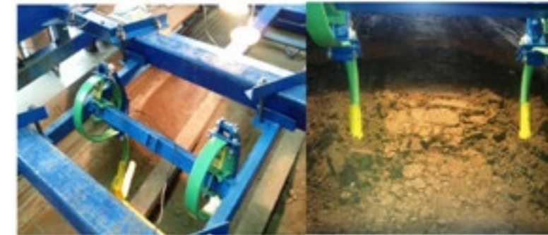
Рисунок 4. Общий вид канала с исследуемым рабочим органом КПП-3 закрепленным на платформе подвижной тележки: а) рабочий орган перед проходом; б) рабочий орган после экспериментального прохода на глубине 12 см
