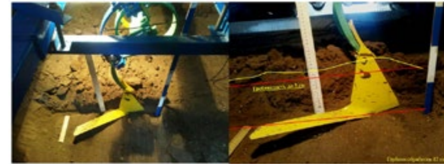
Рисунок 6. Определение профиля дна борозды после прохода рабочего органа культиватора КПП-3 закреплённого на упругих S-образных стойках с регулируемой жесткостью
