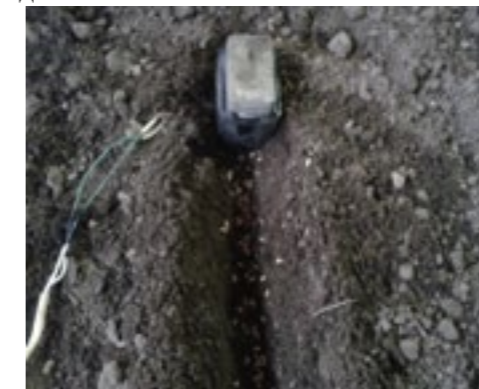
Рисунок 4. Магнитная обработка почвенного ложа с семенами с использованием электромагнита ( B = 170 мТл)
