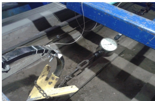
Рисунок 2. Нагружение стойки КПЭ-3,8 заданным усилием в 3824 Н
