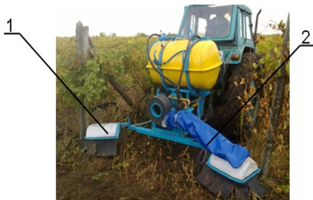
Рисунок 3. Лабораторно-полевая экспериментальной установка опрыскивателя навесного гербицидного виноградникового
