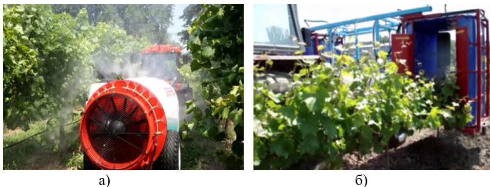
Рисунок 1. Опрыскиватели: а) вентиляторный опрыскиватель; б) камерный опрыскиватель
