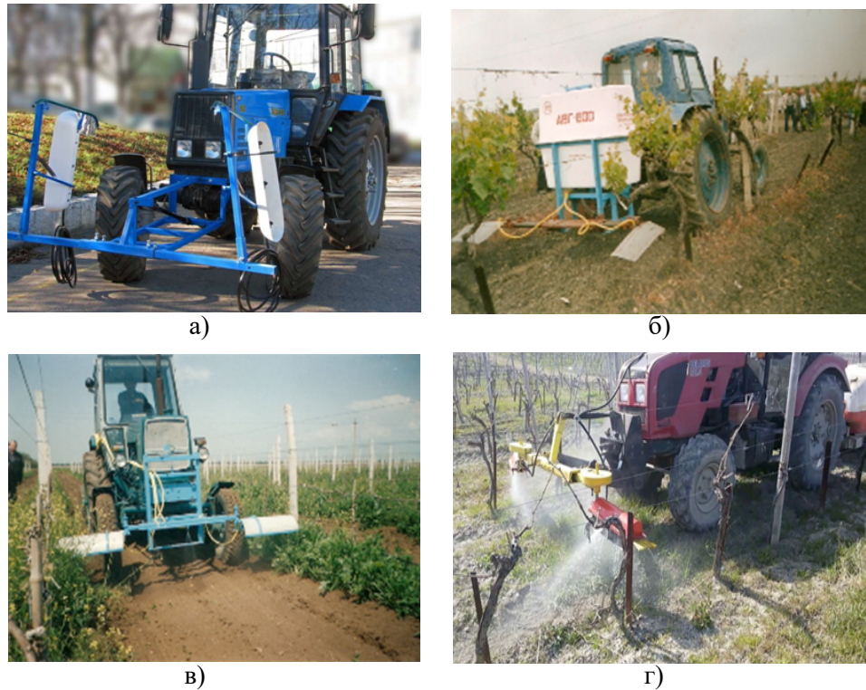
Рисунок 1. Гербицидные опрыскиватели: а) навесно опрыскиватель ЗУБР НШ Г/ДС-2; б) агрегат для внесения гербицидов на виноградниках «АВГ – 600»; в) машина для внесения гербицидов «МВГ – 300/500»; г) опрыскиватель гербицидами
