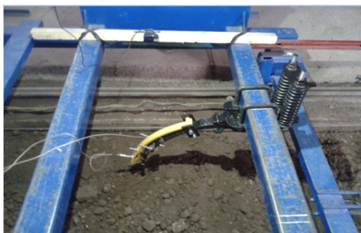
Рисунок 4. Фотоснимок испытания утонченной стойки с навешенным виброударным механизмом (молотком)
