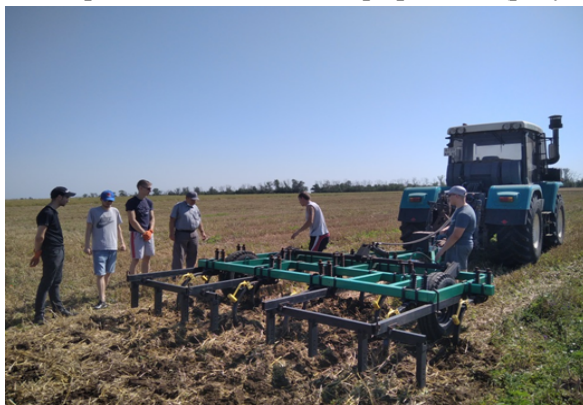
Рисунок 3. Полевые исследования тягового сопротивления культиватора КПЭ-3,8М с рычажными виброударными механизмами на рабочих органах
