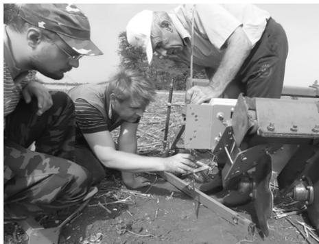
Рисунок 2. Установка рабочего положения колеса ИП-297 относительно основания диска культиватора дискового комбинированного КДК4,5 с применением уровня
