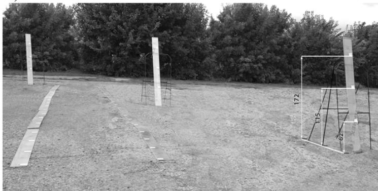
**Рисунок 4. Расстановка планшетов по отношению к краю конического сопла технического средства на расстояниях, принятых равным 5, 10 и 15 м**
