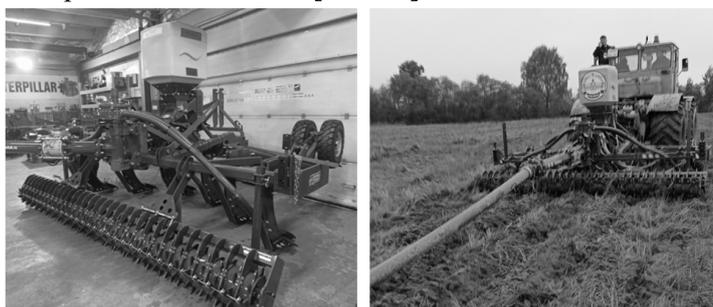
**Рисунок 2. Общий вид комбинированного орудия для глубокого внутрипочвенного внесения жидких органических удобрений с одновременным высевом сидеральных культур**
