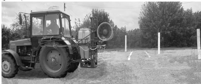
**Рисунок 5. Нанесение капель на карточки из воздушно-капельного потока, создаваемого подачей факелов распыла щелевыми распылителями в воздушный поток начального участка струи**
