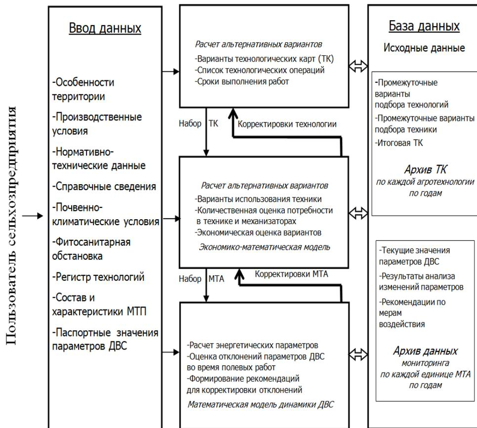
**Рисунок 1.** Схема информационной модели автоматизации подбора агротехнологий и тракторного парка растениеводческого сельхозпредприятия
