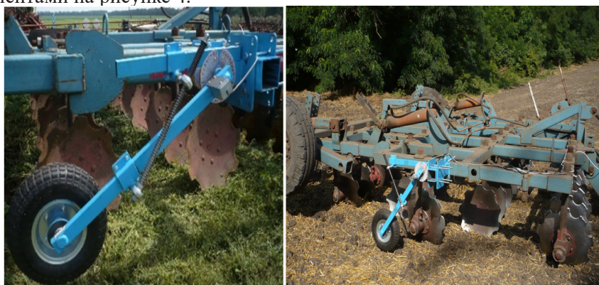
Рисунок 4. Установка ИП–279 на консоли рамы дисковой бороны БДТМ–3,8 (фрагменты)
