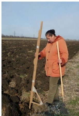
Рисунок 2. Измерение борзодомером величины заглубления в почву корпусов плуга ПЛН–5–35 после его прохода
