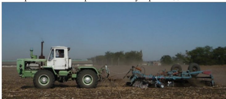
Рисунок 3. Общий вид ИП–279 в составе МТА (Т-150К + борона дисковая БДТМ-3,8)
