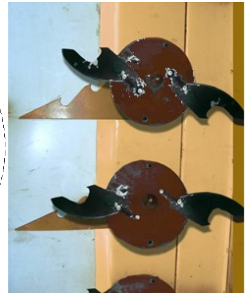
Схемы контакта ветки с шарнирными ножами с прямым и криволинейным лезвием
