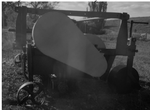
Рисунок 7. Общий вид подборщика-измельчителя виноградной лозы частично модернизированной конструкции
